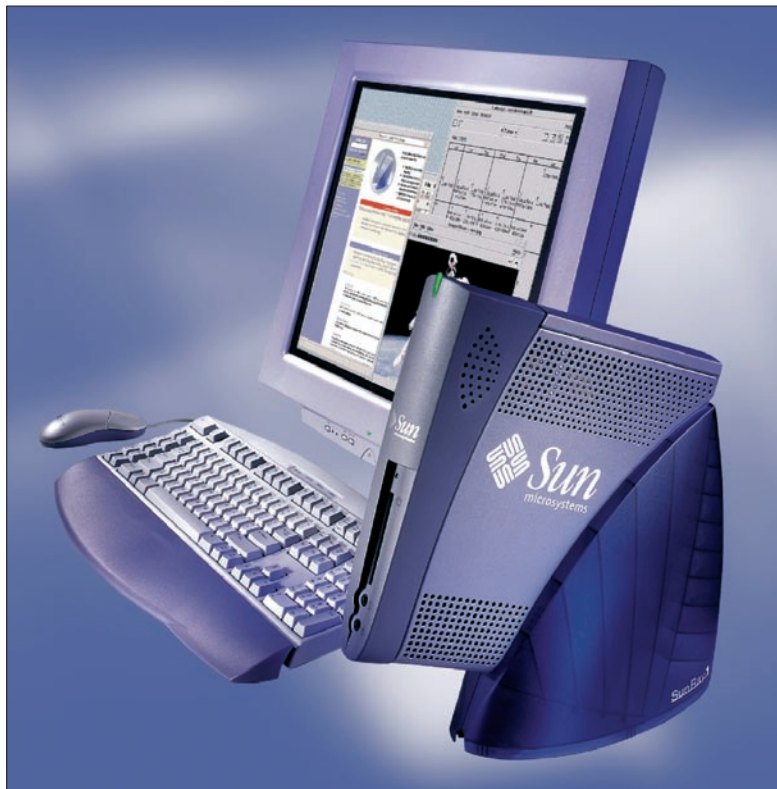
Abbildung 5: Auch Thin Clients – hier die Sun Ray 1g – können einen Beitrag zu hoher Verfügbarkeit leisten. Sie selbst schützen geringe Komplexität, und der zugehörige Server ist in der Regel redundant ausgelegt.
